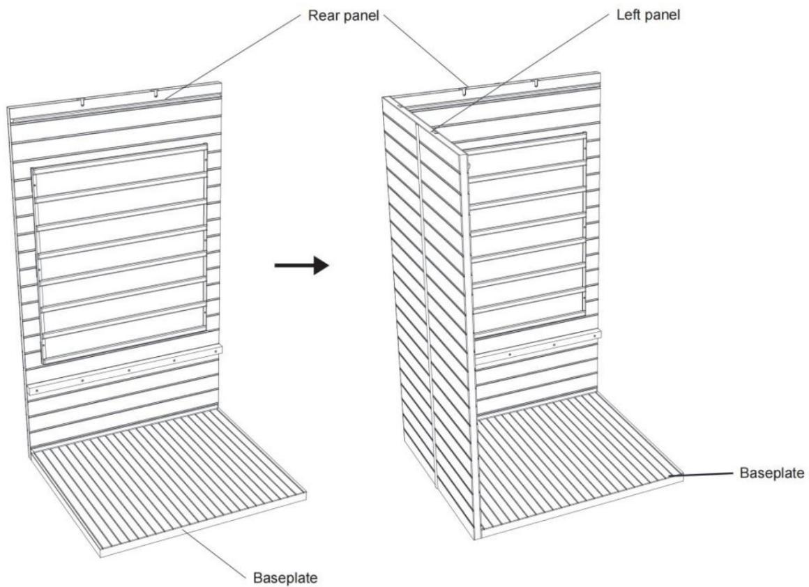
Retirez le panneau arrière et le panneau gauche, placez-le à la position correspondante derrière la plaque de base.
