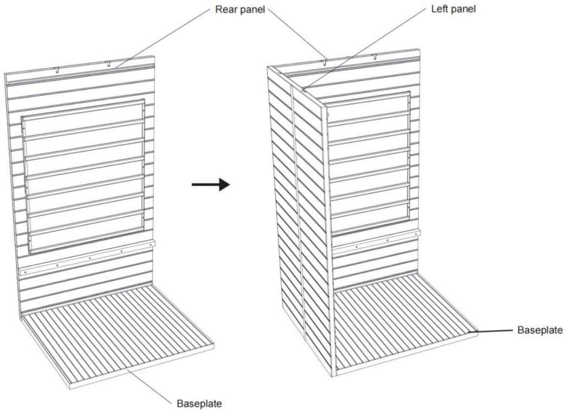
Nehmen Sie die Rückwand heraus und platzieren Sie die linke Platte an der entsprechenden Position hinter der Grundplatte.
