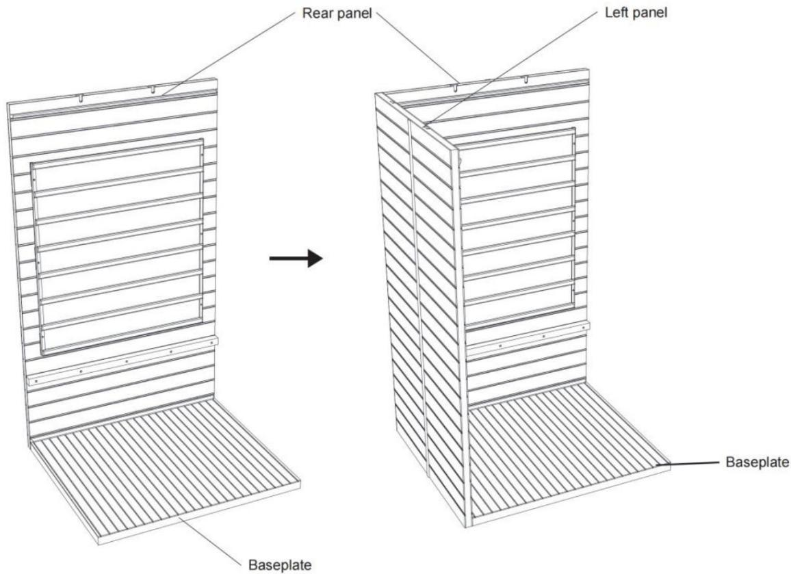
Verwijder het achterpaneel en het linkerpaneel en plaats het op de overeenkomstige positie achter de basisplaat.
