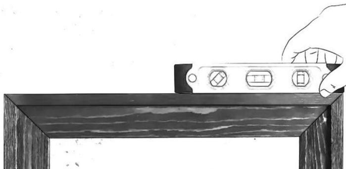
**8. Se necessario, adottare le misure appropriate per livellare l'oggetto.**
