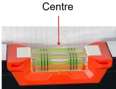
3. Kontrollera ditt vattenpass för noggrannhet före användning.
