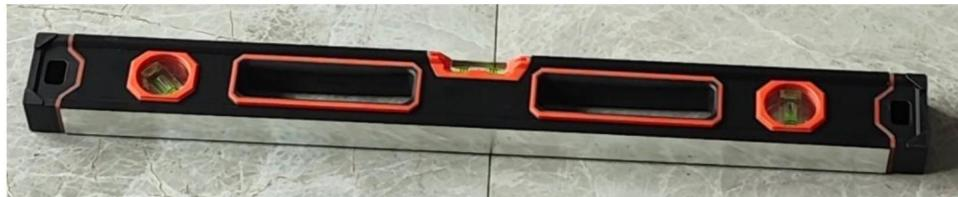
La livella a bolla da 32 pollici è lunga 600 mm, con angoli misurabili di 0, 45 e 90 gradi. Se si acquista il modello SP-C4 o SP-C6, la superficie di lavoro inferiore è magnetica e il resto dei modelli non è magnetico.
