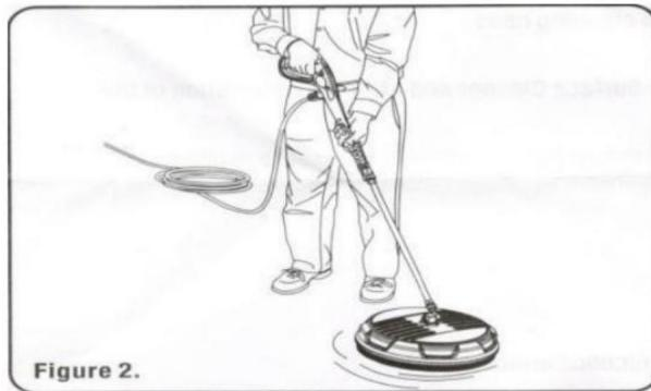
1. Sluit de slang aan op de hogedrukreiniger en start de hogedrukreiniger.
