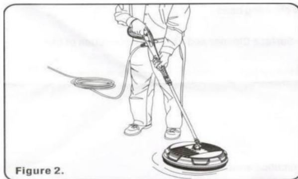
1. Connectez le tuyau au nettoyeur haute pression et démarrez le nettoyeur haute pression.
