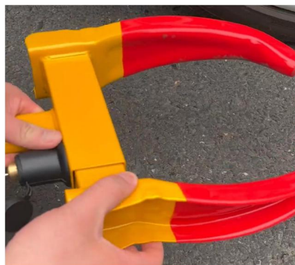
Étape 2 : Ouvrez un côté de la languette de verrouillage
