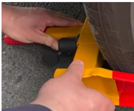
Krok 5: Wciśnij rdzeń zamka
