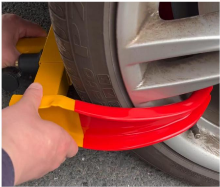
Paso 4: Deslice la cerradura en el cubo
