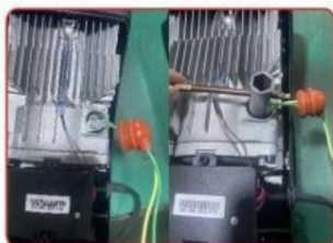
Étape 3 La troisième étape consiste à ouvrir le bouchon de boucle, retirer la bougie d'allumage avec clé spéciale
