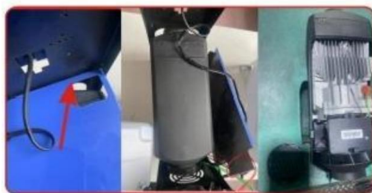
Fase 2 Rimuovere la piastra centrale e il coperchio superiore della macchina split
