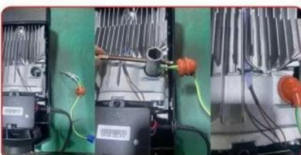
Fase 4 Sostituire la nuova accensione spina Fissare il tappo della fibbia
