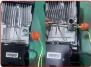
Stap 3 De derde stap is het openen van de gespkip, verwijder ontstekingsbougie met speciale sleutel
