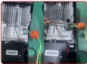
Schritt 3 Der dritte Schritt besteht darin, das Schnallenkappe, Zündkerze entfernen mit Spezialschlüssel
