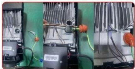
Stap 4 Vervang de nieuwe ontsteking Sluit de gespdop aan
