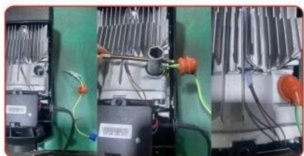
Schritt 4 Ersetzen Sie die neue Zündung Stecker Befestigen Sie die Schnalle Kappe
