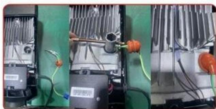
Fase 5 Sostituire la nuova candela di accensione Fissare il cappuccio della fibbia
