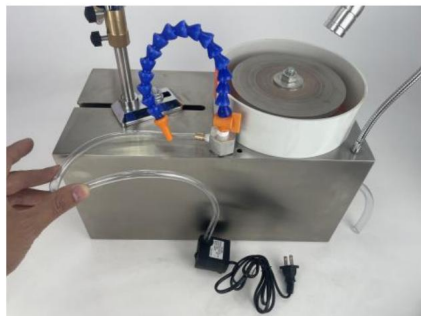
Kran jest podłączony do pompy wodnej
