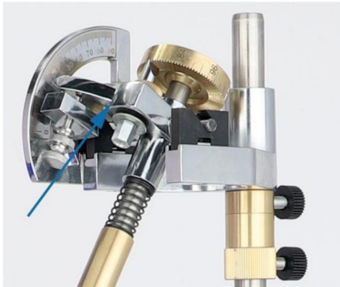
Levier de commande manuel contrôle l'angle de la gemme
