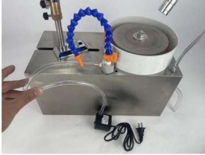
De kraan is aangesloten op de waterpomp
