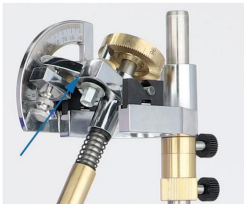
La leva di controllo manuale controlla l'angolo della gemma
