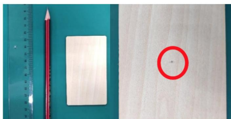
Rysunek 1 Narysuj punkt środkowy na przedmiot grawerowany
