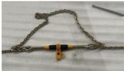
3. Coloque el interruptor en BAJAR, inserte el mango en el orificio del mango y gire el mango en el sentido de las agujas del reloj hacia adelante y hacia atrás para tensar la cadena.
