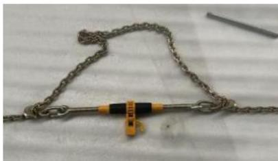
3. Impostare l'interruttore su ABBASSARE, inserire la maniglia nel foro della maniglia e girare la maniglia in senso orario avanti e indietro per tendere la catena; Impostare l'interruttore su superiore e ruotare la maniglia in senso antiorario avanti e indietro per liberare la catena.
