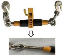
2. Tire de la cadena con fuerza con la mano y luego enganche la cadena con el tensor, como se muestra en la imagen.
