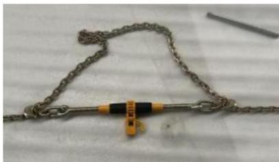
3. Ustaw przełącznik na pozycję LOWER, włóż uchwyt do otworu uchwytu i przekręć uchwyt zgodnie z ruchem wskazówek zegara tam i z powrotem, aby naprężyć łańcuch; Ustaw przełącznik w pozycji górnej i przekręć uchwyt przeciwnie do ruchu wskazówek zegara tam i z powrotem, aby zwolnić łańcuch.
