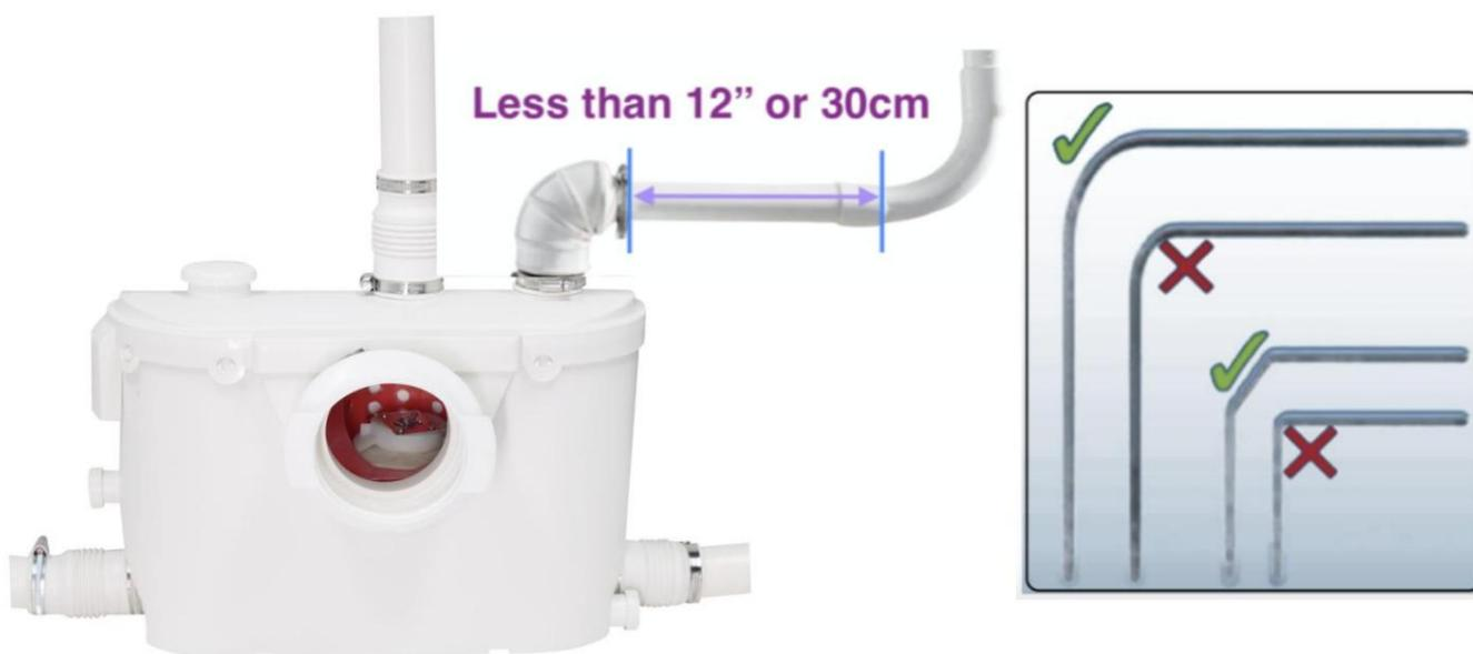
Następnie nachyl się o 2%-3%, aby doprowadzić rurę odprowadzającą wodę do głównego rurociągu, w przeciwnym razie ścieki powrócą do przepływu. Ponadto położenie łokcia PVC water pipe must use 135° big elbow, but not 90° elbow, otherwise, it will flow back.
