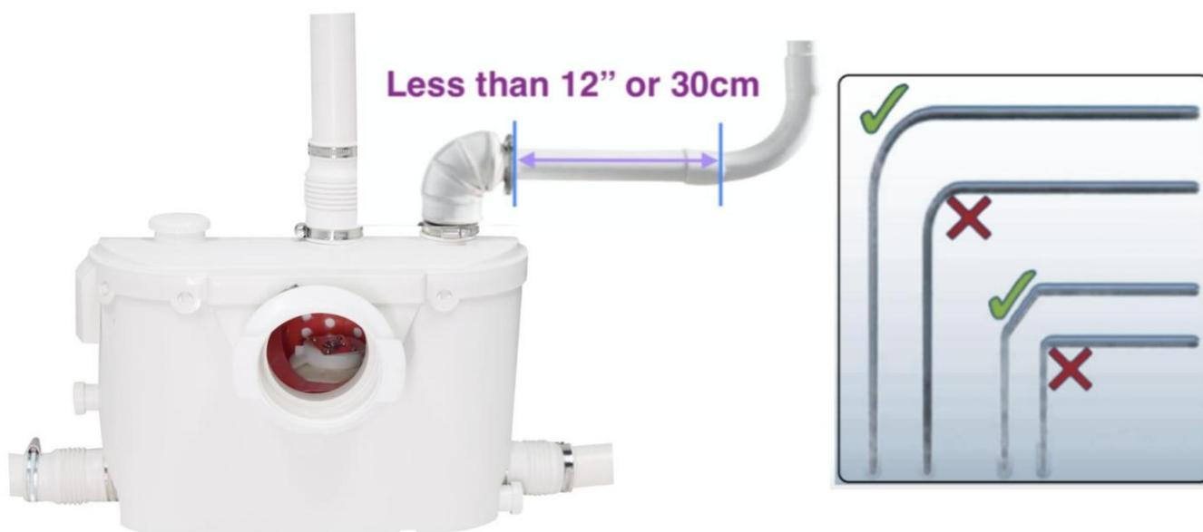
Dan 2%-3% hellen om de waterafvoerleiding naar de hoofdleiding te leiden, anders zal het rioolwater terugstromen. Bovendien is de elleboogpositie van PVC water pipe must use 135°big elbow, but not 90°elbow, otherwise, it heeft invloed op het bereik.
