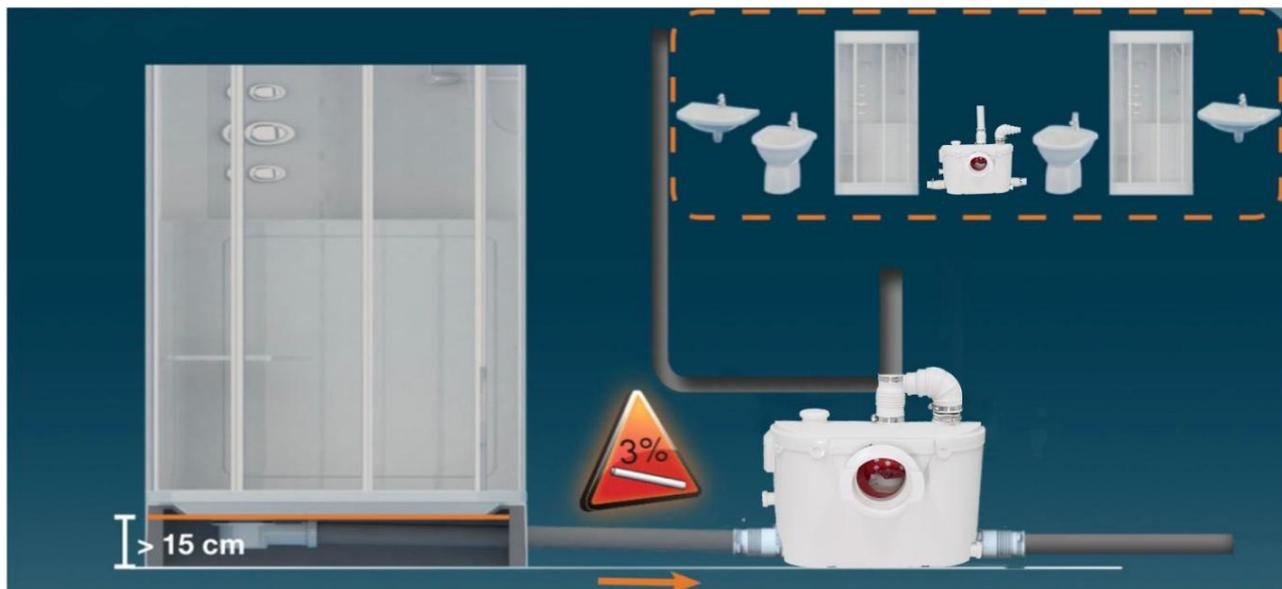
Achtung: Bitte heben Sie das Duschaum-Chassis mindestens 15 cm an. Dies hängt auch von der Entfernung vom Duschaum zur Wasserpumpe ab.
