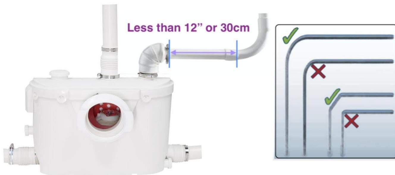
Dann neigen Sie das Wasserabflussrohr um 2 % bis 3 %, um es zur Hauptleitung zu führen, da das Abwasser sonst zurückfließt. Außerdem ist die Winkelposition des PVC water pipe must use 135°big elbow, but not 90°elbow, otherwise, it wirkt sich auf die Reichweite aus.
