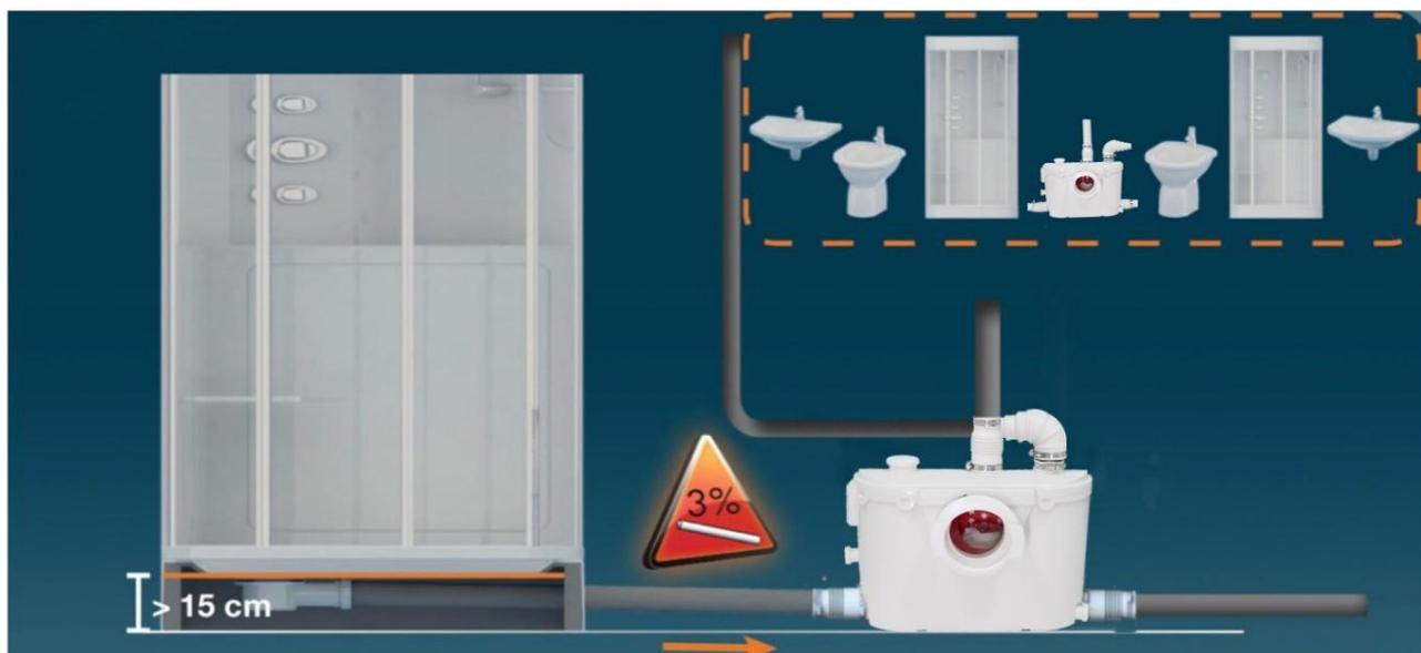
Uwaga: proszę podnieść podwozie kabiny prysznicowej o nie mniej niż 15 cm. Jest to również zależne od odległości od kabiny prysznicowej do pompy wodnej.
