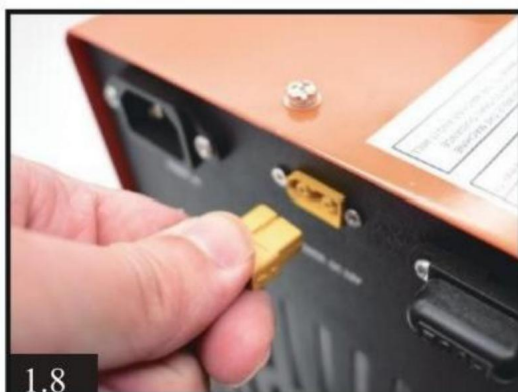
Utilizzo dell'alimentazione della batteria dell'auto DC 12V
