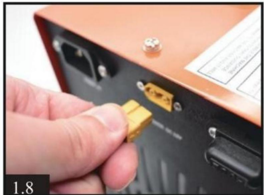
Utilisation de l'alimentation de la batterie de voiture DC 12V
