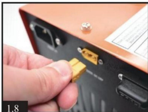
Korzystanie z zasilania z akumulatora samochodowego DC 12V
