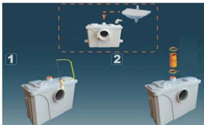
(6-4), Jeśli toaleta nie jest podłączona, możesz użyć pokrywy (J), aby zablokować wlot wody toaletowej, a nastą pnie użyć zacisku (G), aby zamocować toaletę . Nastę pnie podłącz tylko umywalkę , prysznic i pralkę .
