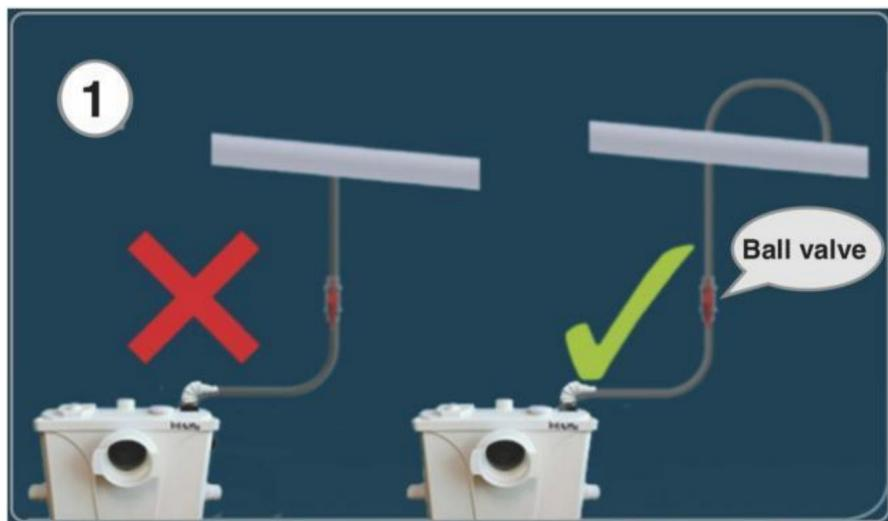
(5-6), Für eine optimale Leistung bitte zuerst nach oben ablassen und dann die Abflussrohr mit einer Neigung von 2%-3% an das Hauptrohr anschließen: Andernfalls wird das Abwasser zurückfließen.
