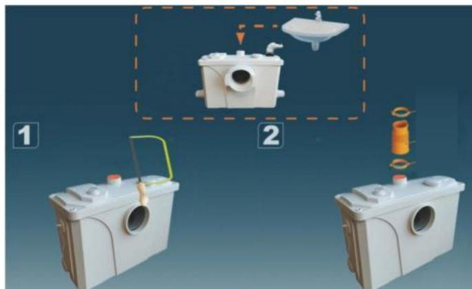
(6-4), Wenn die Toilette nicht angeschlossen ist, können Sie den Wasserzulauf der Toilette mit dem Deckel (J) blockieren und die Toilette dann mit der Klemme (G) befestigen. Schließen Sie dann nur noch Waschbecken, Duschraum und Waschmaschine an.
