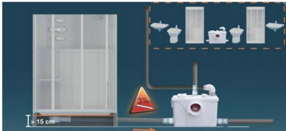
(6-3), Si necesita conectar más equipos y utilizar la entrada de agua superior, ábrala con una sierra y conéctela con una manguera.
