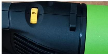
Ne forcez pas la polisseuse. Le poids de l'unité fournit un pression, laissez donc le tampon de polissage et la polisseuse faire le travail. Candidature une pression supplémentaire ne fait que ralentir le moteur, use rapidement le tampon de polissage et réduit considérablement la vitesse de polissage. Une pression excessive entraînera une surcharge le moteur, causant d'éventuels dommages dus à une surchauffe.
