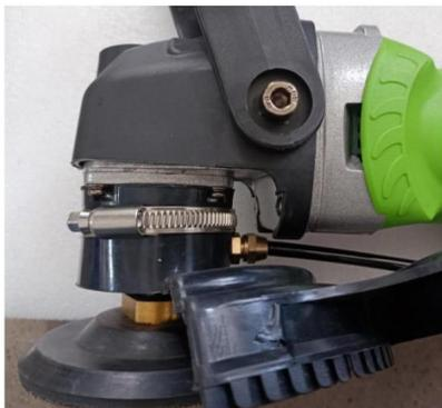
3. Montieren Sie die Schleifplatte und wählen Sie das passende Polierpad aus.
