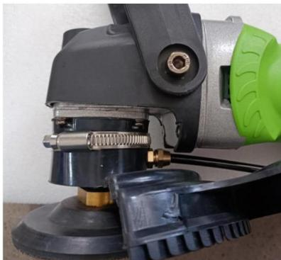
3. Installez la plaque de meulage et sélectionnez le tampon de polissage approprié.
