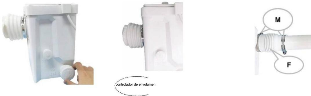
El tamaño de la tubería para conectar las aguas residuales de la ducha o del lavabo a la bomba es de 40 mm. Si se conecta la ducha, la base de la misma debe elevarse 20 cm y la tubería de drenaje debe mantener una pendiente del 3 % para permitir que las aguas residuales fluyan hacia la bomba por gravedad, evitando que las aguas residuales se queden en la tubería de entrada y produzcan olor.
