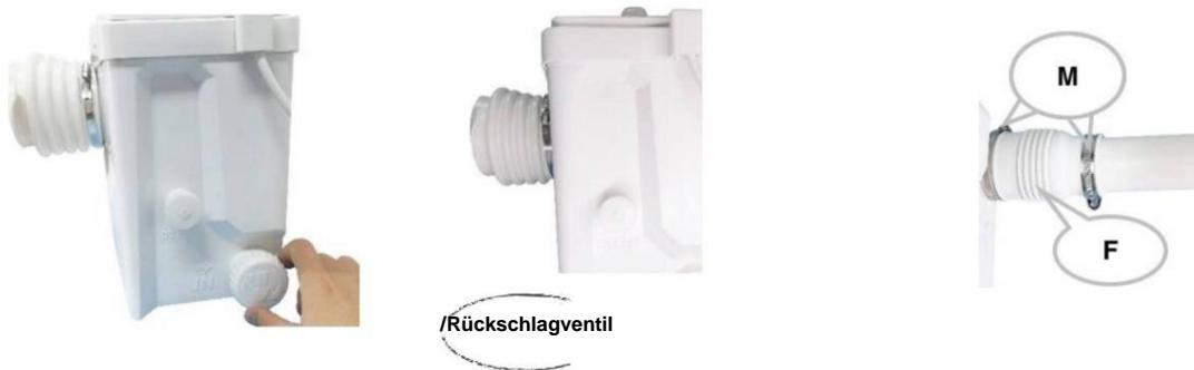
Die Rohrgröße zum Anschluss des Abwassers aus Dusche oder Waschbecken an die Pumpe beträgt 40 mm. Beim Anschluss der Dusche muss der Boden der Dusche um 20 cm angehoben werden, und das Abflussrohr muss eine Neigung von 3 % aufweisen, damit das Abwasser durch die Schwerkraft in die Pumpe fließen kann und verhindert wird, dass das Abwasser im Zulaufrohr hängen bleibt und einen Geruch erzeugt.
