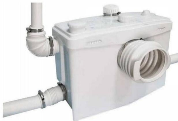
Nota: per ottenere le migliori prestazioni della pompa, prima scaricare verso l'alto, poi orizzontalmente. Quando si scarica orizzontalmente, il tubo di scarico deve avere una pendenza verso il basso di 10-15 gradi. Non utilizzare gomiti ad angolo retto (90 gradi), poiché influenzerebbero l'effetto di sollevamento verticale.
