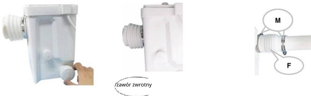
Rozmiar rury do podłączenia ścieków z prysznica lub umywalki do pompy wynosi 40 mm. W przypadku podłączenia prysznica dno prysznica musi zostać podniesione o 20 cm, a rura spustowa musi zachować nachylenie 3%, aby ścieki mogły spływać do pompy grawitacyjnie, zapobiegając gromadzeniu się ścieków w rurze wlotowej i powstawaniu nieprzyjemnego zapachu. Jeśli nie podłączasz toalety, użyj akcesorium (G), aby zatkać wlot wody z przodu pompy. Zapoznaj się z poniższym schematem instalacji:
