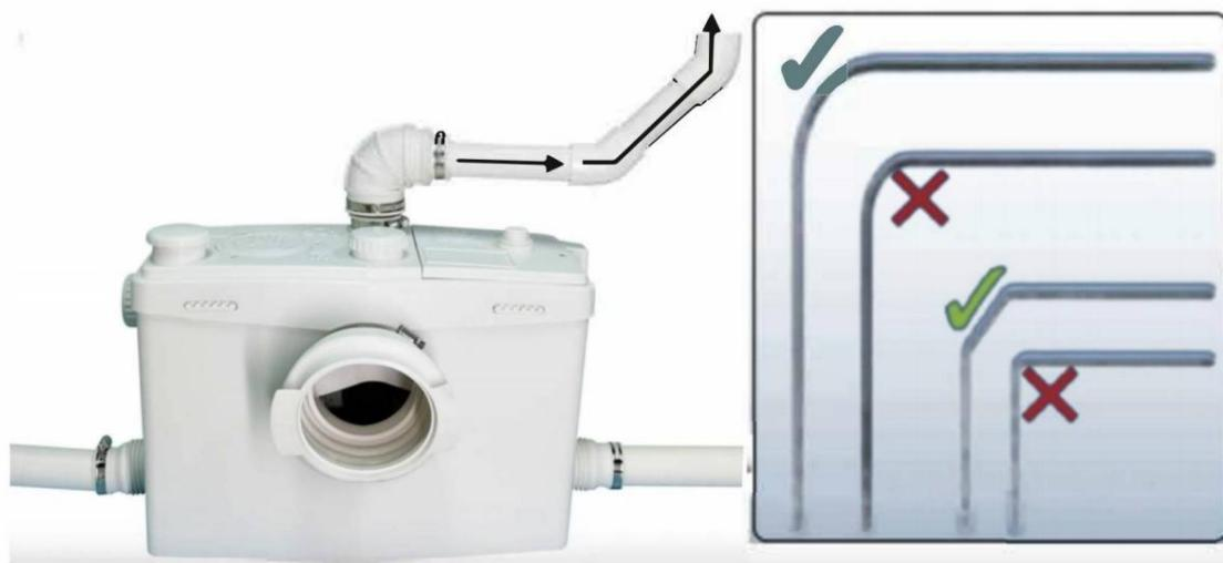
Schematyczny diagram rury spustowej zamontowanej z boku przedstawia się następująco:
