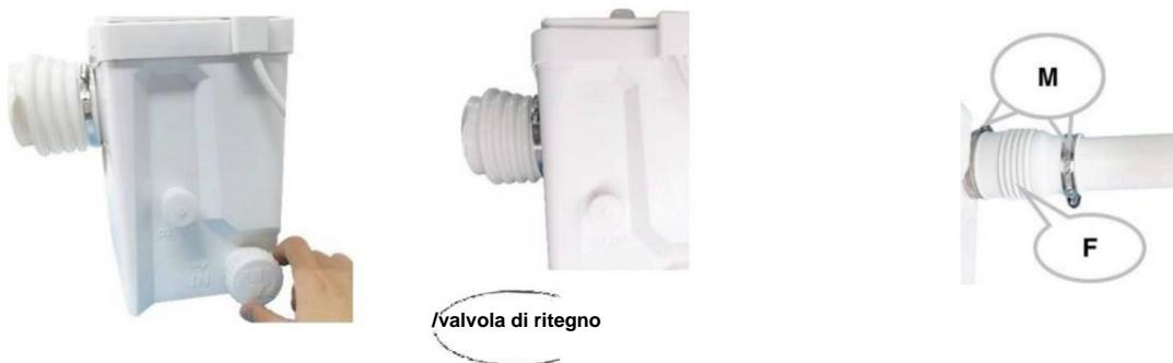
La dimensione del tubo per collegare le acque reflue della doccia o del lavandino alla pompa è di 40 mm. Se si collega la doccia, il fondo della doccia deve essere sollevato di 20 cm e il tubo di scarico deve mantenere una pendenza del 3% per consentire alle acque reflue di fluire nella pompa per gravità, impedendo alle acque reflue di rimanere nel tubo di ingresso e produrre odore.
