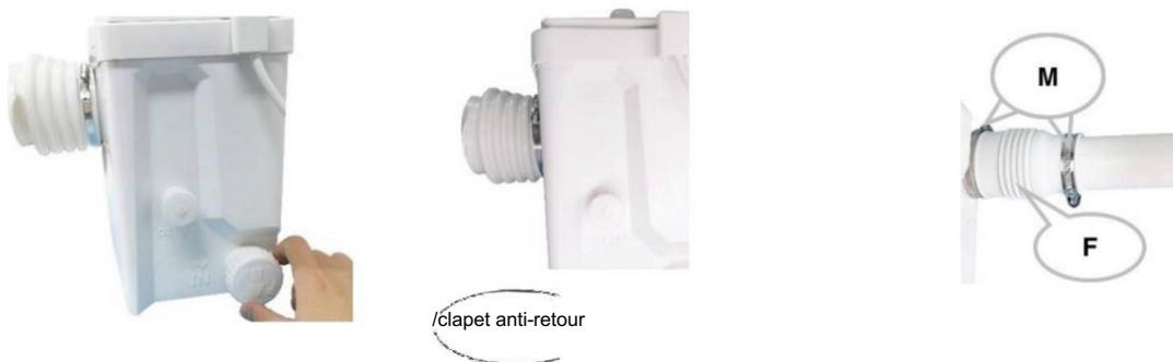
Le diamètre du tuyau de raccordement des eaux usées de la douche ou du lavabo à la pompe est de 40 mm. En cas de raccordement à la douche, le fond de la douche doit être surélevé de 20 cm et le tuyau d'évacuation doit conserver une pente de 3 % pour permettre aux eaux usées de s'écouler dans la pompe par gravité, empêchant ainsi les eaux usées de rester dans le tuyau d'admission et de produire une odeur.
