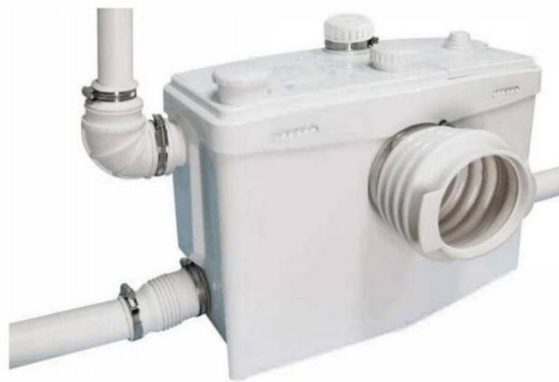
Uwaga: Aby uzyskać najlepszą wydajność pompy, najpierw opróżnij w góre, a następnie w poziomie. Podczas opróżniania w poziomie rura spustowa powinna mieć nachylenie w dół wynoszące 10-15 stopni. Nie używaj kolanek o kącie prostym (90 stopni), ponieważ wpłyną one na efekt podnoszenia pionowego.
