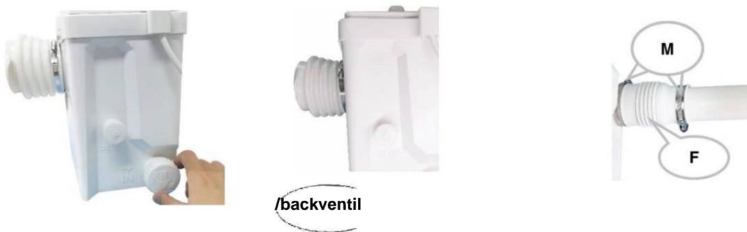
Rörstorleken för anslutning av dusch- eller tvättställsavloppsvatten till pumpen är 40 mm. Om duschen ansluts måste duschens botten höjas med 20 cm, och avloppsröret måste hålla en lutning på 3 % för att låta avloppsvattnet strömma in i pumpen genom gravitationen, vilket förhindrar att avloppsvattnet stannar i inloppsröret och producerar en odör. Om du inte ansluter en toalett, använd tillbehör (G) för att plugga vatteninloppet på framsidan av pumpen. Se följande installationsschema:
