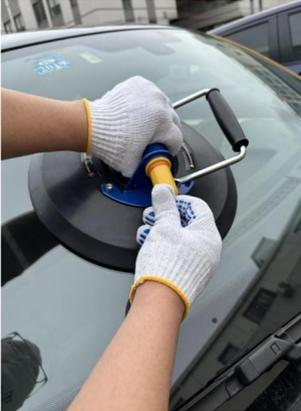
3. Plaats tijdens het gebruik de vacuümzuignap plat op het oppervlak van het te adsorberen object en druk de vacuümzuignap lichtjes aan met uw hand om volledig contact tussen het rubber te garanderen.
