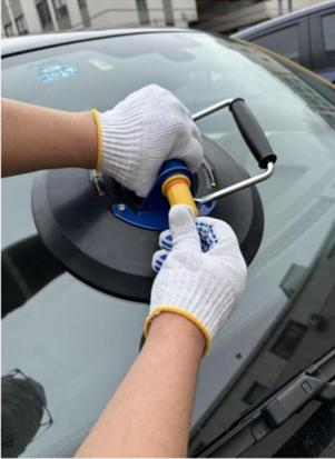
3. När du använder, placera vakuumsugkoppens plant på ytan av föremålet som ska adsorberas, tryck lätt på vakuumsugkoppens med handen för att säkerställa full kontakt mellan gummit
