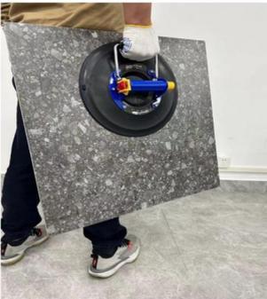
4. Controleer na volledige inflatie de rode waarschuwingslijn om te zien of deze is ingetrokken. Als deze niet is ingetrokken, kan het object worden verplaatst.
