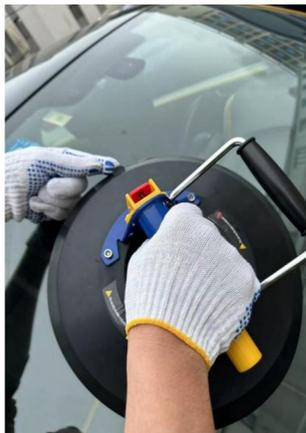
5. Po zakończeniu procesu transportu po wykonaniu tej czynności delikatnie podnieś deflację język lub naciśnij czarną deflację przycisk, aby usunąć przysawkę.
