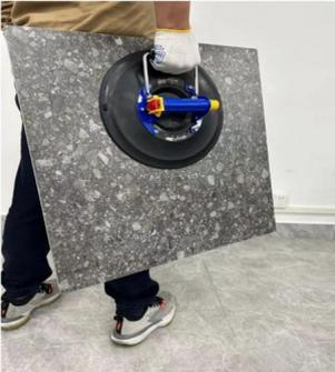
4. Efter fullständig uppblåsning, kontrollera den röda varningslinjen för att se om den har dragits tillbaka. Om den inte har dragits tillbaka kan objektet flyttas.
