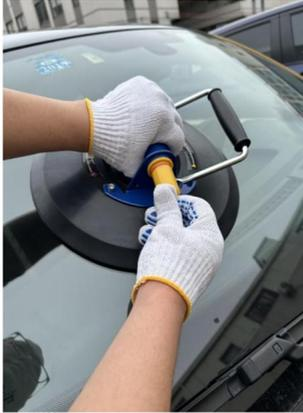
3. Durante el funcionamiento, coloque la ventosa de vacío plana sobre la superficie del objeto a adsorber, presione ligeramente la ventosa de vacío con la mano para asegurar el contacto completo entre la goma y la superficie del objeto. Luego presione el botón de inflado hasta que esté completamente inflado y la línea roja de advertencia no sea visible.
