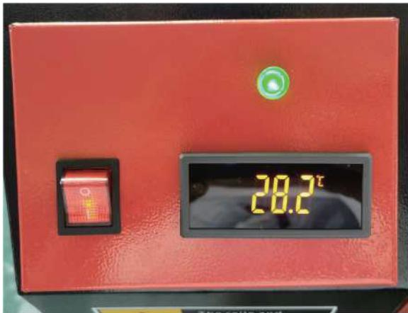
★ Bitte beachten Sie, dass die Wassertemperatur während des Gebrauchs 35 Grad Celsius nicht überschreiten sollte, da der Laser sonst beschädigt werden kann. Wenn die Umgebungstemperatur kurz vor dem Absinken unter 0 Grad Celsius steht, ersetzen Sie ihn bitte durch Frostschutzmittel, um Schaden am Kohlendioxidglas zu vermeiden Laser.
